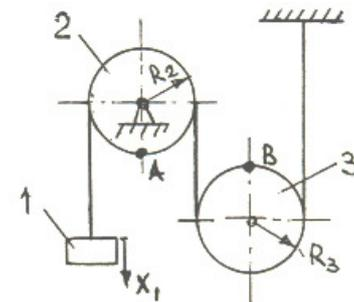
3. Визначити швидкість тіла 1 коли його шлях  $S_1 = 2 \text{ м}$ , якщо механічна система з 3 тіл починає рухатися із стану спокою під впливом сили ваги тіла 1.
